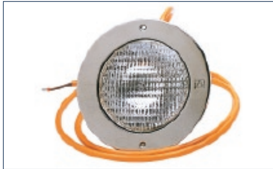
Unterwasserscheinwerfer aus V4A mit Lampe PAR 56, 300 W/12 V
